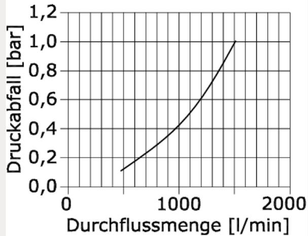
**Durchfluss Diagramm Wasser**
