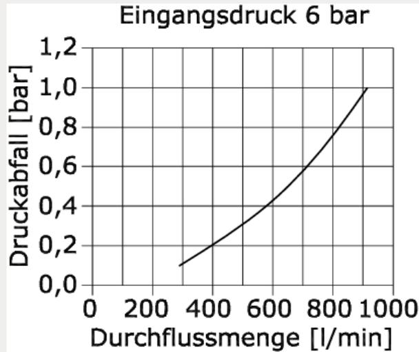
**Durchfluss Diagramm Wasser**
