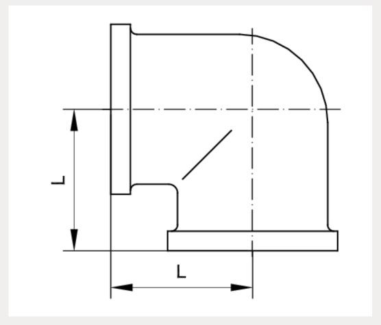
MADER Winkelstück aus Messing mit zylindrischem Innengewinde, abgerundete Ausführung 227197
