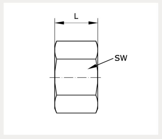
MADER Überwurfmutter aus Messing für 2/3-Schlauchverschraubungen 227296
