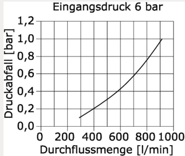
**Durchfluss Diagramm Wasser**
