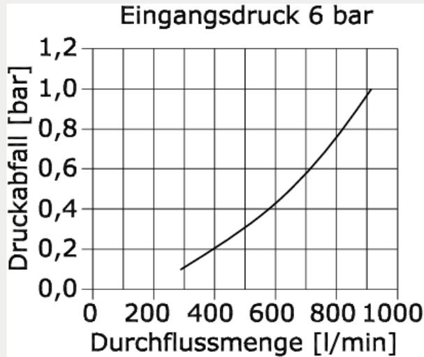
**Durchfluss Diagramm Wasser**
